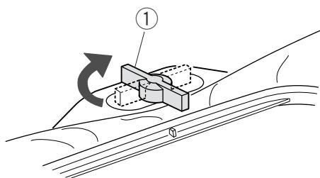
Поверните установочный винт по часовой стрелке.
