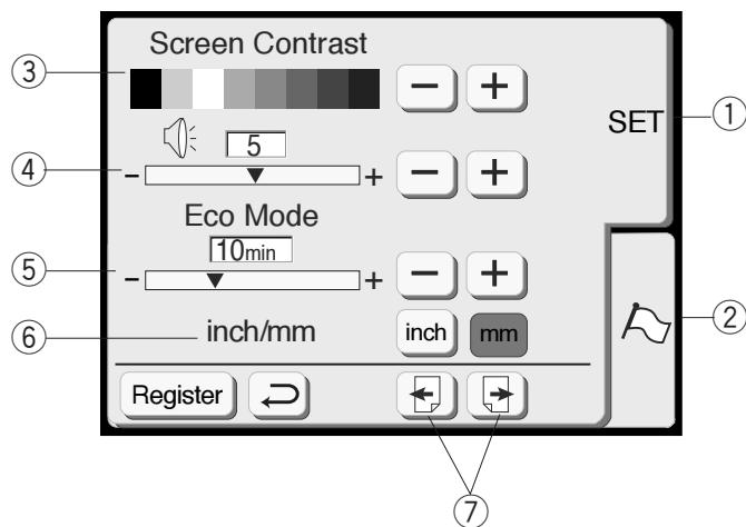
Нажмите на клавишу "Установки" (SET), чтобы открыть экран режима установок машины.
