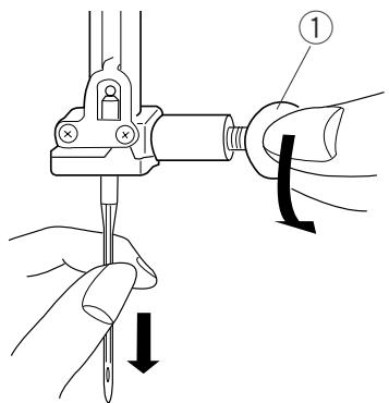
Отключите питание. Повернув маховое колесо, поднимите иглу и опустите прижимную лапку. Ослабьте винт игольного стержня, повернув его против часовой стрелки. Вытащите иглу из зажима.
