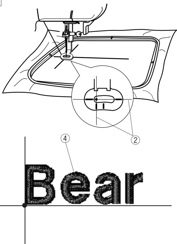
5 Используйте клавишу центровки для выравнивания положения пялец относительно центральных линий.
