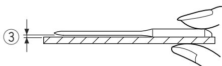
Чтобы проверить качество иглы, положите её плоской стороной на ровную поверхность (игольную пластину, стекло и т.д.). Зазор между иглой и плоской поверхностью должен быть одинаковым.
