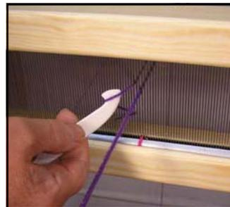
5. С помощью крючка, пропустив один зуб берда, проведите нить сквозь следующий зуб. Сматывая нить с клубка, накидывайте петли на держатель основы. Теперь следующая пара нитей проходит сквозь бердо.
