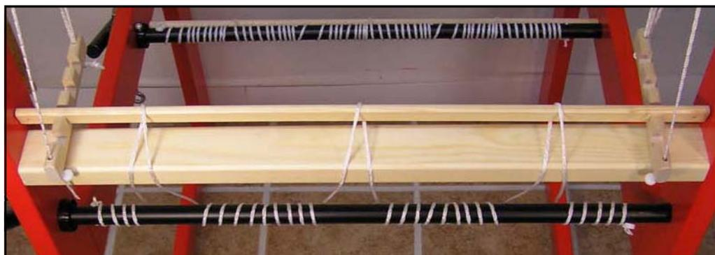
4. Опустите поперечную планку навои на держатели ремизок. Закройте собачку храповика навои и натяните шнуры планки. Выровняйте поперечную планку по центру.
