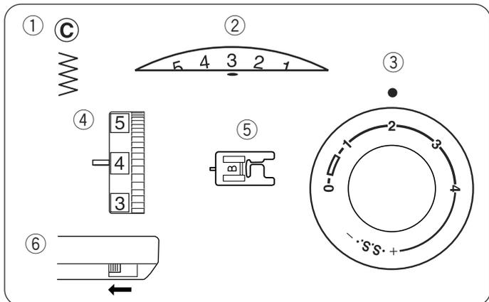
Удалите нить из иглы. Измените ширину зигзага так, чтобы игла сквозь прорезь на лапке попадала в отверстия пуговицы. Поверните маховое колесо и проверьте, входит ли игла в отверстия пуговицы. Опустите прижимную лапку, чтобы закрепить пуговицу на месте. Отверстия в пуговице должны совпадать с прорезью на лапке.
